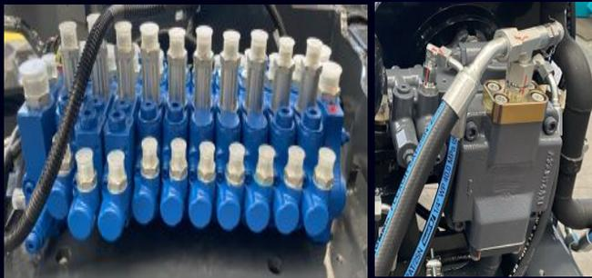
Progettato con sistema load sensitive. Fornisce un controllo preciso e una risposta rapida dei vari elementi con carico diverso e senza alcuna interferenza tra loro. Le prestazioni di un controllo esperto sono garantite.
