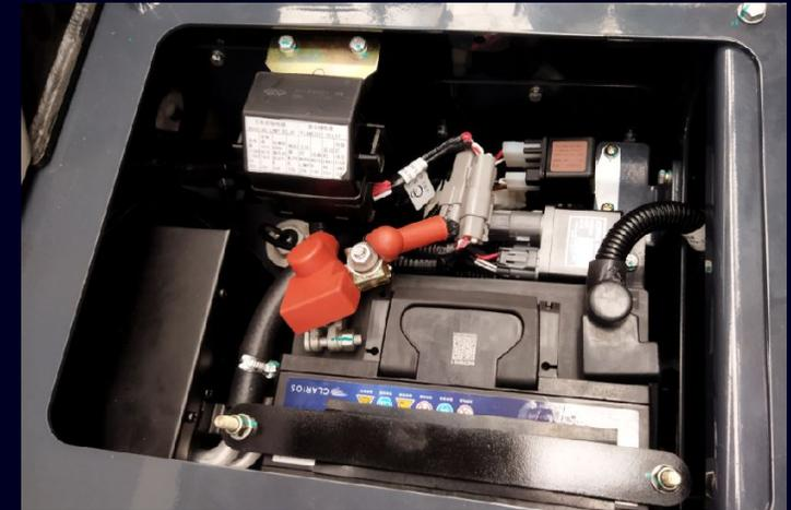
La batteria, la scatola dei fusibili, i relè e il sensore del livello dell'olio possono essere facilmente raggiunti semplicemente capovolgendo il sedile.
