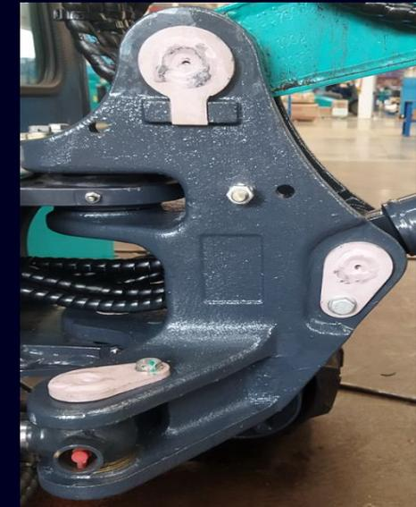
Con il metodo di fusione integrale, il nuovo supporto del braccio ha una maggiore resistenza strutturale rispetto alle piastre d'acciaio saldate.
